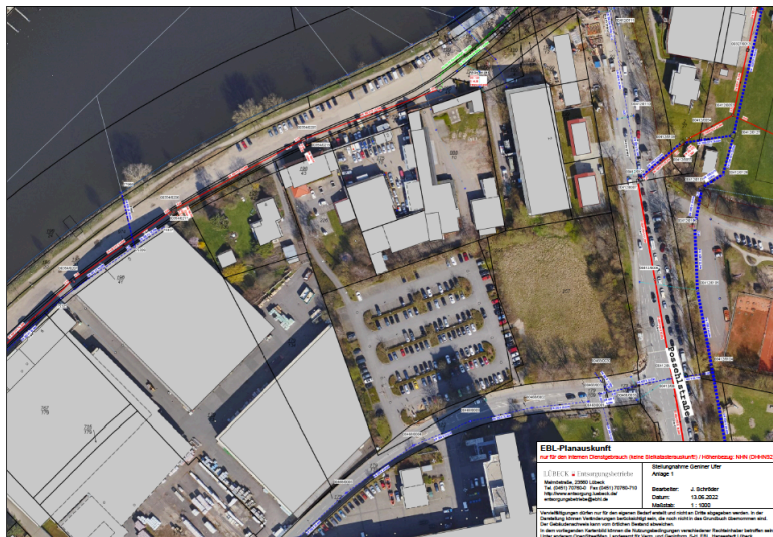
Anlage 1: vorhandene Schmutzwasser- und Regenwasserkanalisation
